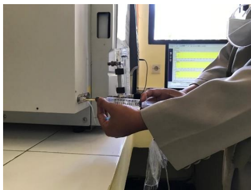
Gambar 3. Analisis konsentrasi gas metana dengan metode kromatografi gas (GC)
