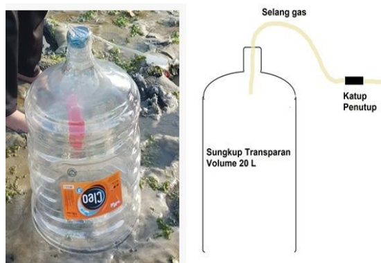
Gambar 2. Desain sungkup pengambilan gas
